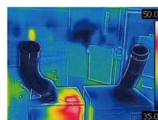
従来品 排気が熱い Pure Drive 排気が熱くない
